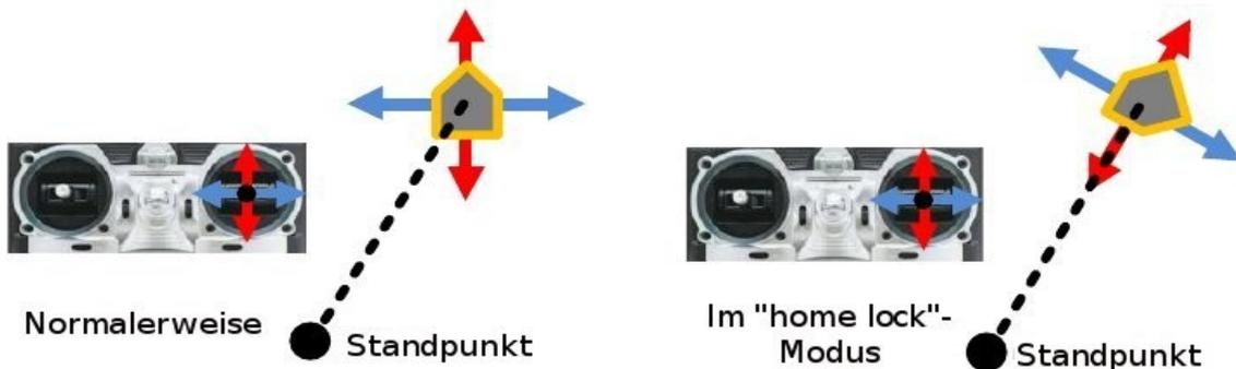
Für die Nutzung der Funktion muß senderseitig ein 2- oder 3-stufiger IOC-Schalter festgelegt werden. Der entsprechende Kanal-Ausgang des Empfängers wird mit dem X2-Eingang des MC-Moduls verbunden. Den Feinabgleich führt man am Sender so durch, daß die einzelnen Schalterstellungen in den korrespondierenden Modi **Home lock**, **Course lock** oder **OFF** zu liegen kommen (Schieber im Programm verfärbt sich an diesen Stellen blau).
