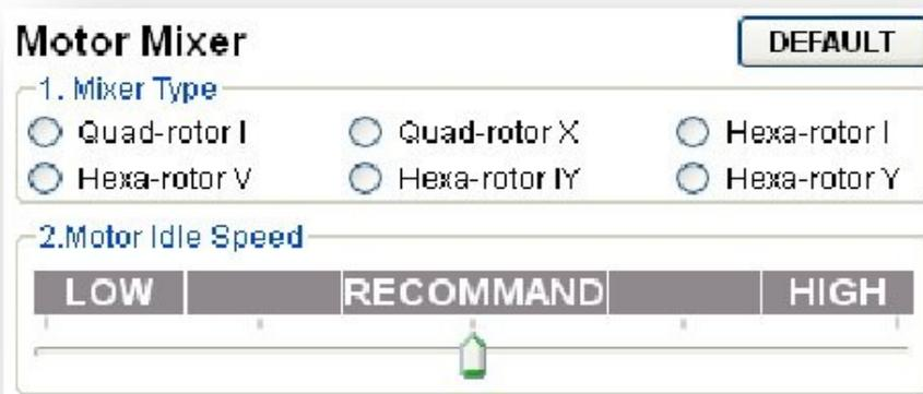
Am RC-Sender ist der 3D-Modus (Acrobatic) zu aktivieren. Danach wählt man die zum Multikopter passende Einstellung unter „Motor-Mixers“.
