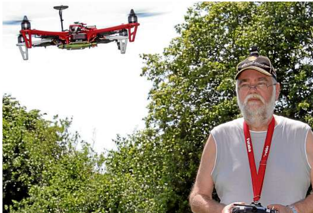
Der Quadrocopter von Wolfgang Zeiger ist über GPS mit mehreren Satelliten verbunden, sodass sich das Fluggerät auch automatisch in der Luft ausbalancieren kann. Fotos: Hennes (2)
