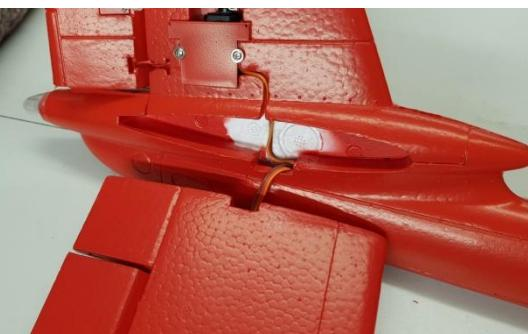
Alle Servokabel sind beschriftet und müssen an den Übergangsstellen zusammengesteckt werden. Anschließend wird das Leitwerk mit dem Rumpf
